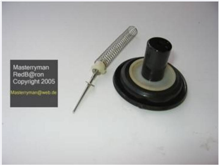
Düsennadel, Beilagscheibe, Sprengring sowie Membrane und Schieber. (Zhong Yu BT 7, Bj 05)
